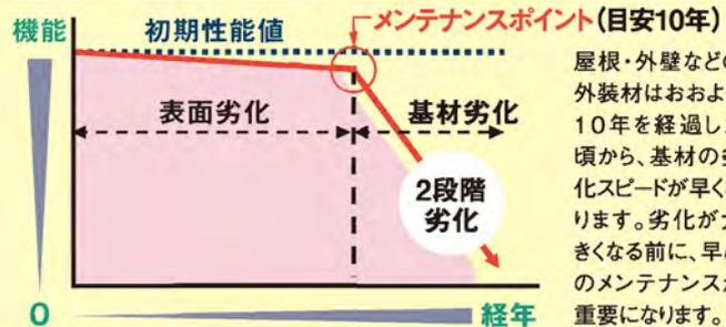
屋根・外壁などの外装材はおおよそ10年を経過した頃から、基材の劣化スピードが早くなります。劣化が大きくなる前に、早めのメンテナンスが重要になります。
